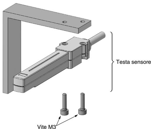
4. Allineare i bulloni all'interno delle rispettive sedi per montare la testa del sensore. Inserire i bulloni dal lato opposto potrebbe danneggiare la testa del sensore.
