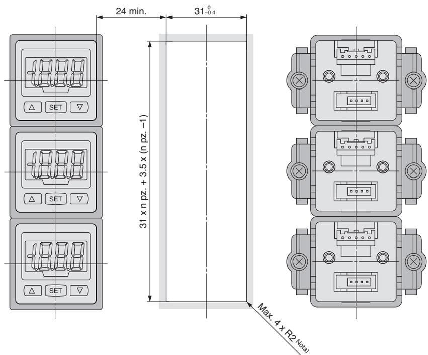
Nota) Se dotato di raggio di curvatura (R), mantenerlo a R2 o meno.
