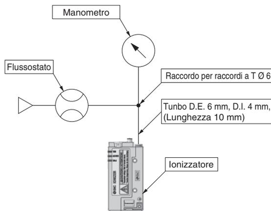
Fig. 1: Circuito di misurazione delle caratteristiche di portata
