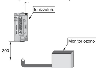
Fig. 2: Circuito di misurazione della condensazione dell'ozono
