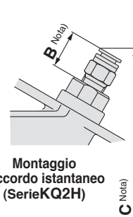
Montaggio raccordo istantaneo (Serie KQ2H)
