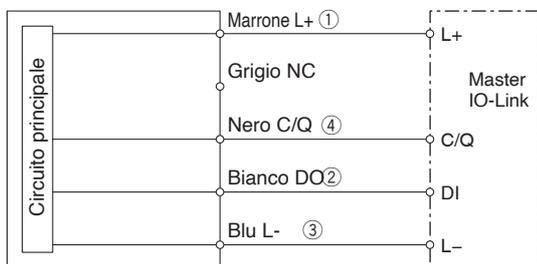
**Uscita digitale 1 e 2 + Uscita analogica in tensione**
