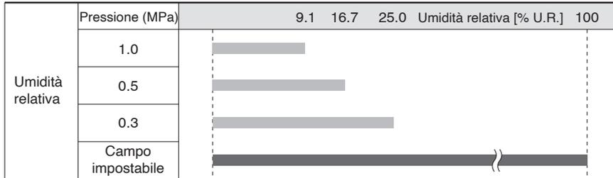
Il campo della pressione atmosferica e dell'umidità relativa che il rilevatore di condensa può misurare cambia a seconda della pressione all'interno della connessione (sotto pressione). Ad esempio, se la pressione all'interno del tubo (sotto pressione) è di 0.3 MPa e l'umidità relativa è del 100 % (valore massimo), l'umidità relativa alla pressione atmosferica quando viene rilasciata nell'atmosfera sarà del 25.0 % U.R.
